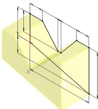
Indiquer dans la fenêtre la **profondeur** de la pièce puis valider.
